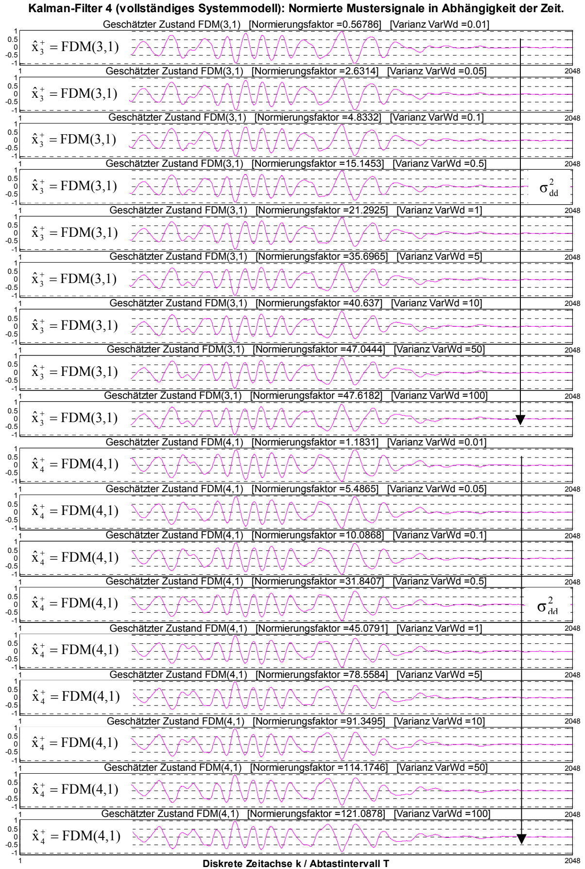
Abb. 9.13: Kalman-Filter 4. Zeitlicher Verlauf der 3. und 4. Komponente des geschätzten Zustandsvektors für die Ausgangssignale nach Abb. 9.11.
