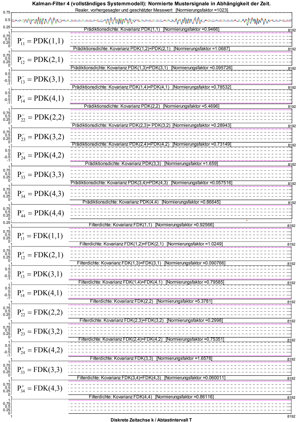
Abb. 9.10: Kalman-Filter 4. Normierte Ausgangssignale und Kovarianzen der Prädiktionsdichte PDK und der Filterdichte FDK in Abhängigkeit der Zeit.
